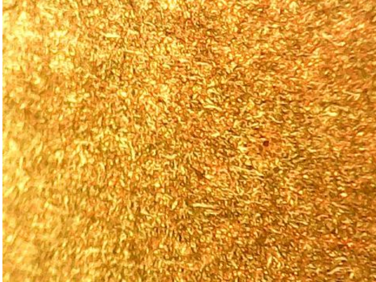
الشكل (11) صورة مجهرية للعينة A تظهر حبيبات المارتنيسيت المرجعة كما نلاحظ وجود تناسق في البنية x200
