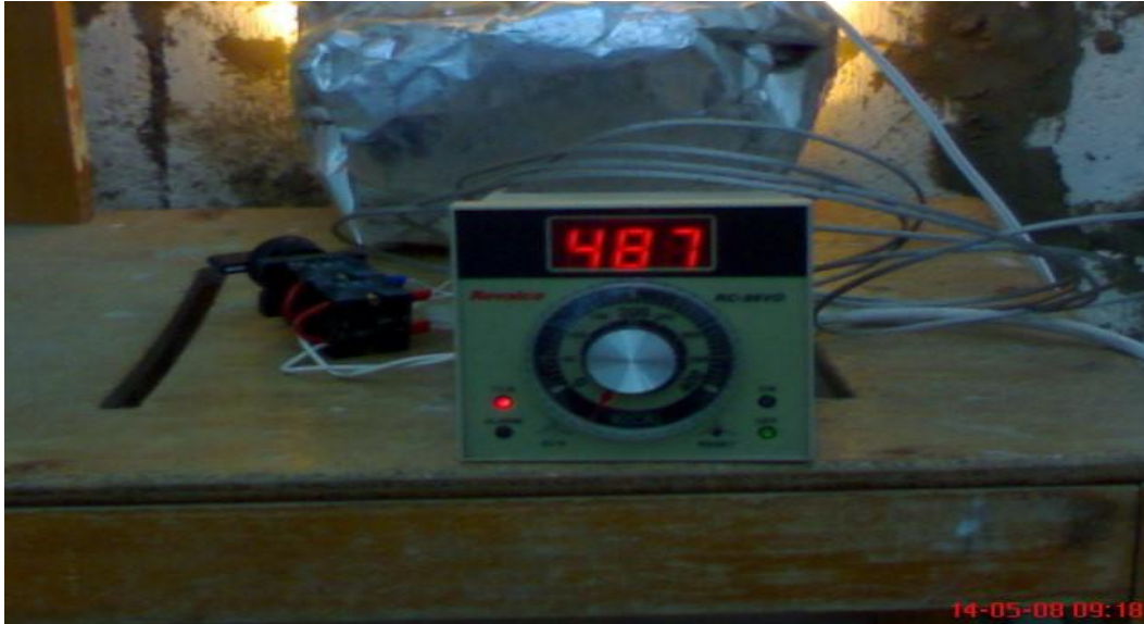
الشكل(5): مقياس الحرارة الديجتال مع المزدوجات الحرارية.
