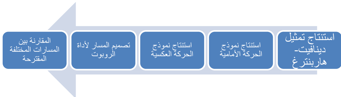
الشكل (3) المراحل الأساسية لنمذجة الروبوت وتصميم المسار لحركة أدواته.
