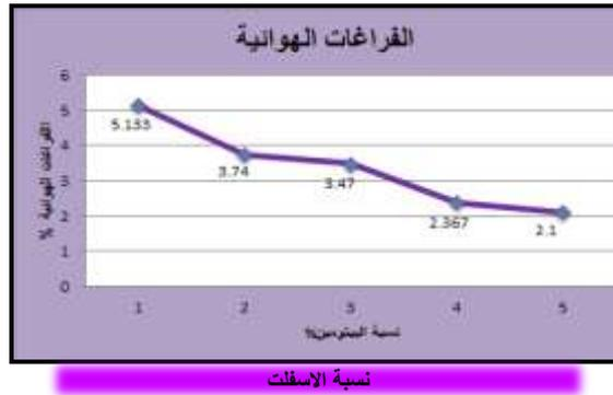
الشكل (4) منحنى الفراغات الهوائية - نسبة الاسفلت في الخلطة التقليدية
