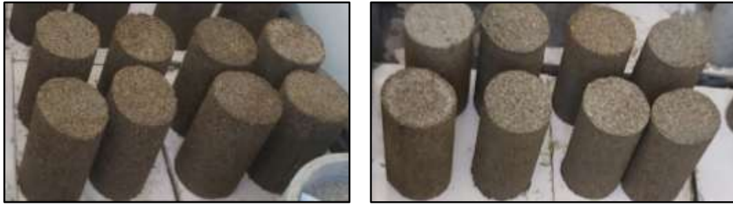
الشكل (8): بعض العينات بعد إخراجها من القالب البلاستيكي
