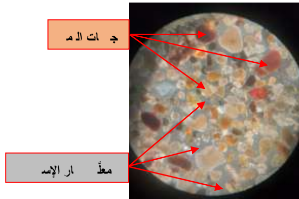
الشكل (4): صورة مجهرية لتغلغل معلق الحقن في التربة الرملية بعد (28) يوم
