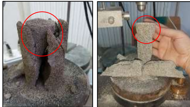
الشكل (17) شكل الكسر عند الانهيار (النمط الثالث)
