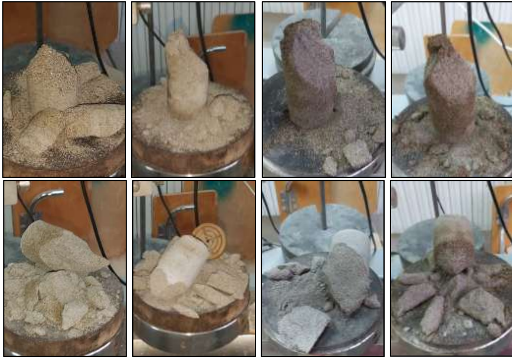
الشكل (16) شكل الكسر عند الانهيار (النمط الثاني)
