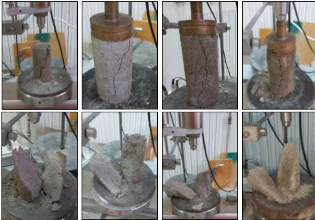
الشكل (15) شكل الكسر عند الانهيار (النمط الأول)
