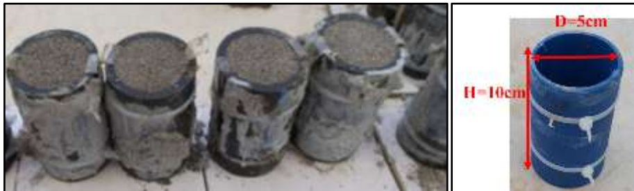
الشكل (5): القالب البلاستيكي المستخدم لأخذ العينات الشكل (6): بعض العينات المحضرة بعد عملية الغرز في التربة المحقونة
