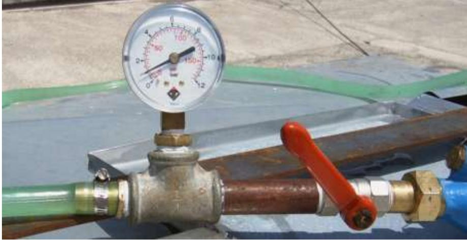
الشكل (4) يوضح سكر لضغط المضخة مع جهاز لقياس ضغط الماء
