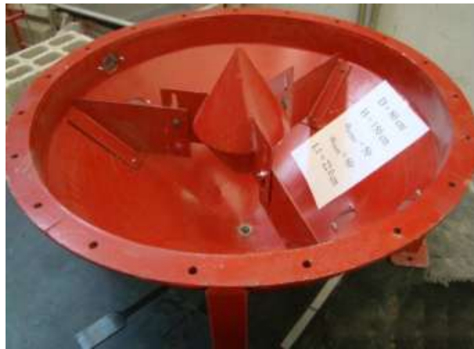
الشكل (18) توضع العنصر المدخل المدروس عند النسبة \frac{h_1}{h_2} = 1
