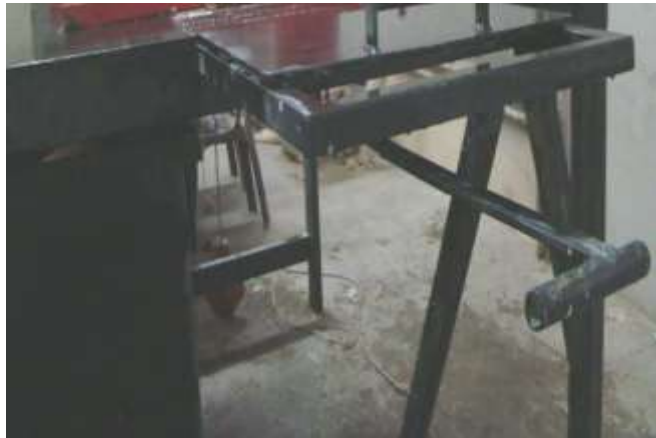
الشكل (10) ذراع التحكم بفتح وإغلاق فتحة المخرج
