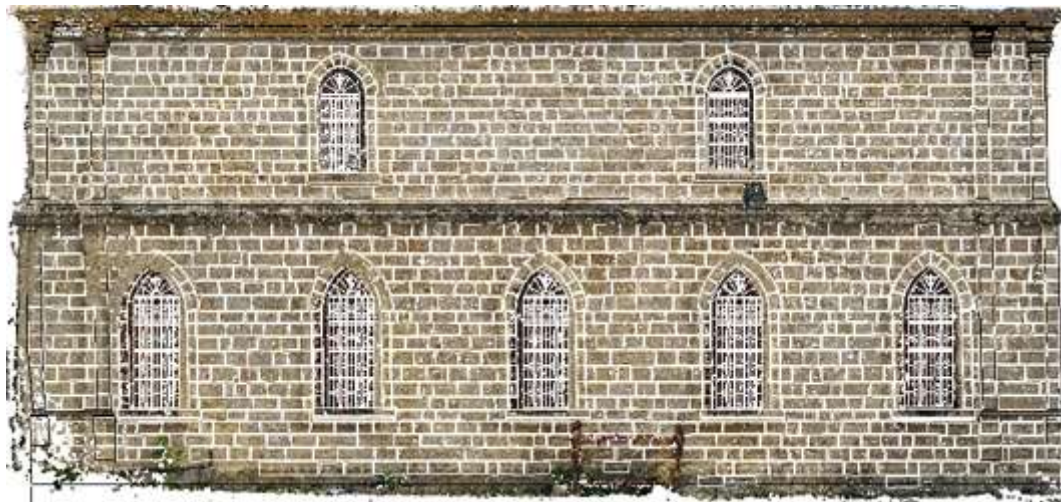
الشكل (11). الرقمنة على غمامة النقاط الكثيفة للواجهة.
