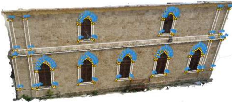
الشكل (10). النمذجة ثلاثية الأبعاد داخل نظام SfM على النموذج الصوري الحقيقي للواجهة.
