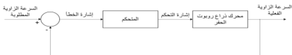
الشكل (1) المخطط الصندوقي لنظام التحكم بذراع روبوت الحفر المقترح
