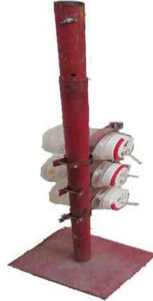
الشكل رقم (11): جهاز قطف عينات الرواسب المحمولة. الشكل رقم (12): جهاز قطف عينات الرواسب المتدرجة على القاع.
