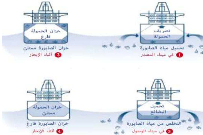
الشكل (1-1) مقطع عرضي في سفينة لحالات شحن وتفريغ مياه الصابورة
