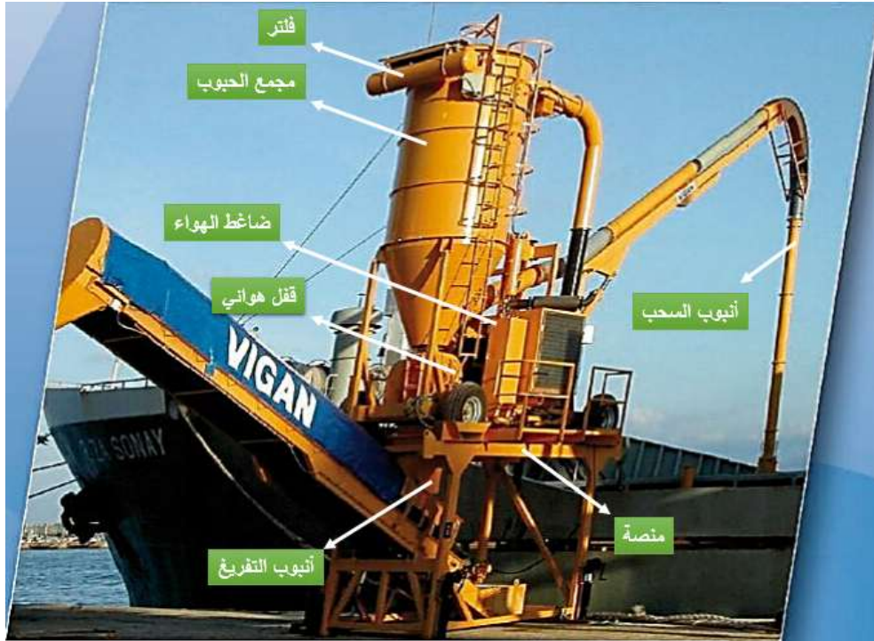
الشكل (1) : الناقل البنيوماتيكي Vigan Mobile Type 200
