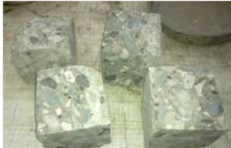
الشكل (6): العينات المكعبية البيتونية من الكتل البيتونية للمبنى المهذوم
