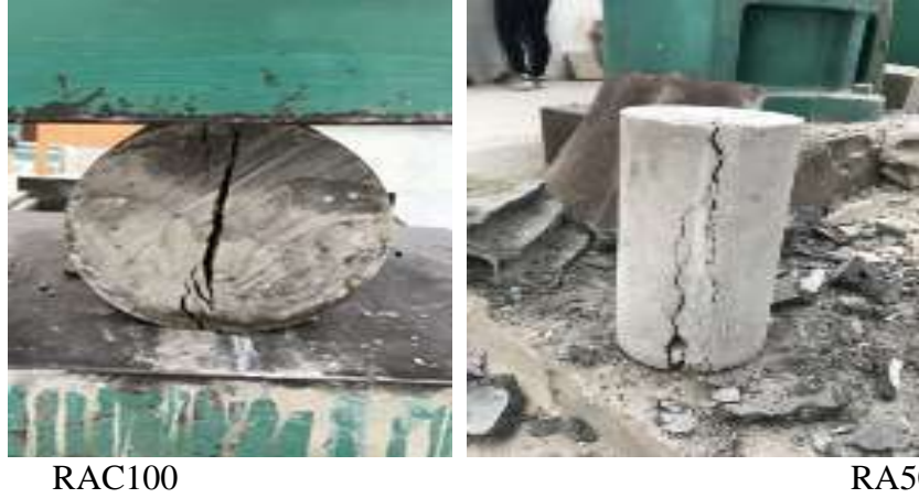
الشكل (9): اختبار العينات على الشد بالفلق
