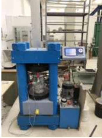
الشكل(5): جهاز اختبار العينات البيتونية على الضغط البسيط
