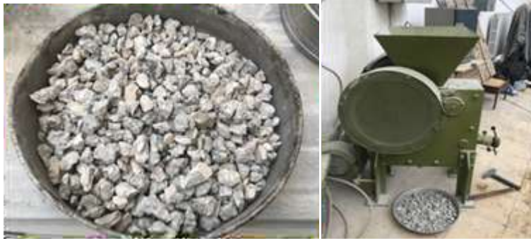
الشكل (3): كسارة الكتل الحجرية الشكل (4): الحصويات البيتونية الناتجة عن إعادة التدوير
