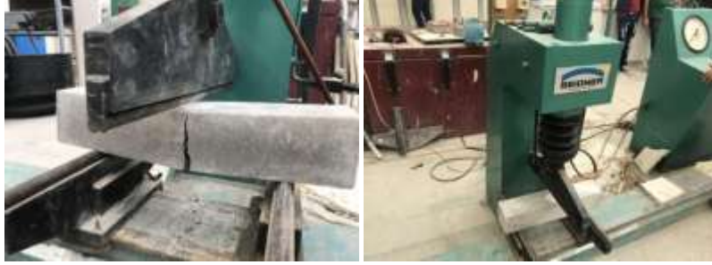
الشكل (11): اختبار العينات على الشد بالانعطاف
