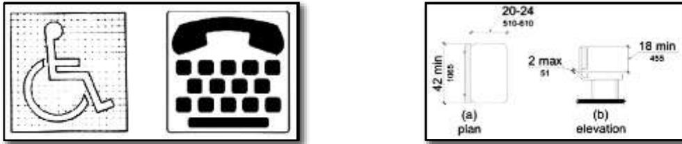
الشكل (4) المصدر [11] أبعاد المقعد المناسبة للمعاقين الشكل (5) المصدر [11] بعض العلامات التوضيحية للمعاقين
