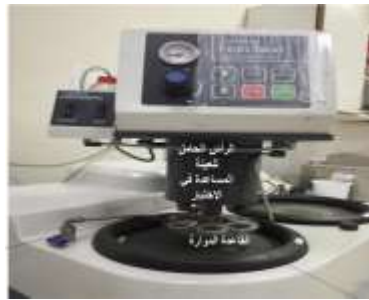
الشكل (14) جهاز التجليخ والتلميع المستخدم في اختبار اهتراء
