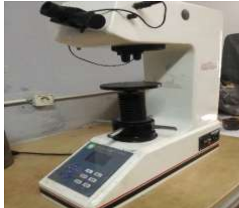
الشكل (11) جهاز قياس القساوة Vickers Hardness Tester
