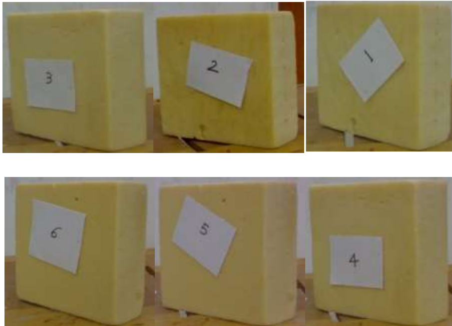
الشكل (2) عينات الاختبار المصنعة من مادة البولي أوريثان
