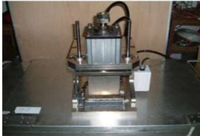
الشكل (1) جهاز قياس مقاومة الانضغاط
