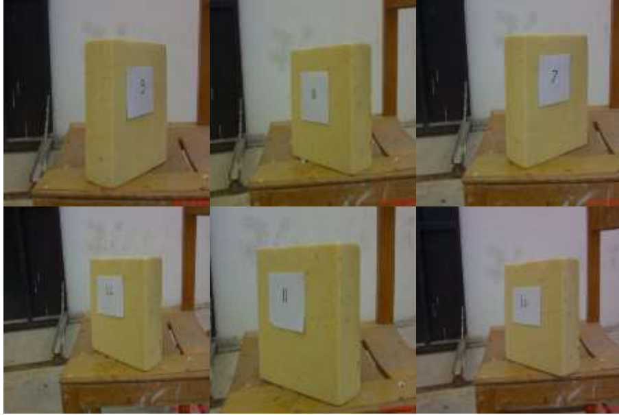
الشكل (3) عينات الاختبار من مادة البولي أوريثان مع إضافة القش
