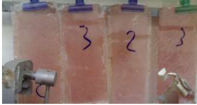
الشكل (3) - عينات من UPR المسلحة بطبقة وطبقتين وثلاث طبقات من الألياف الزجاجية العشوائية - العينات معرضة للتجفيف الطبيعي لمدة ثلاث أشهر بظروف المخبر
