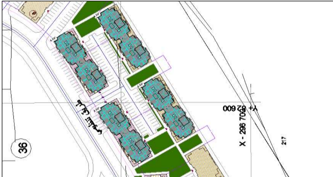
الشكل (13) التجميع المستمر بعد التوجيه بمقدار 5 درجات عكس عقارب الساعة
