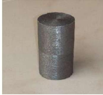
الشكل (2) عينة اختبار الضغط
