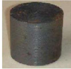
الشكل (3) عينة اختبار الاهتراء
