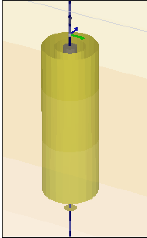
الشكل [2] - طريقة نمذجة الوتد البيتوني وحفرة البنتونايت مع السطوح البينية.
