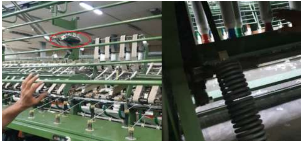
الشكل (1) نوابض بأحجام مختلفة في آلة البرم بمعمل الخيوط القطنية في اللاذقية
