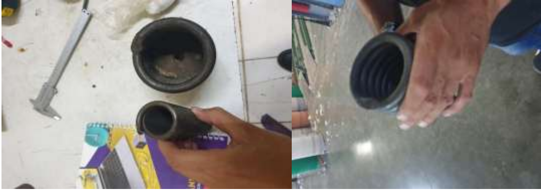
الشكل (2) صور توضح فشل بعض نوابض آلة البرم
