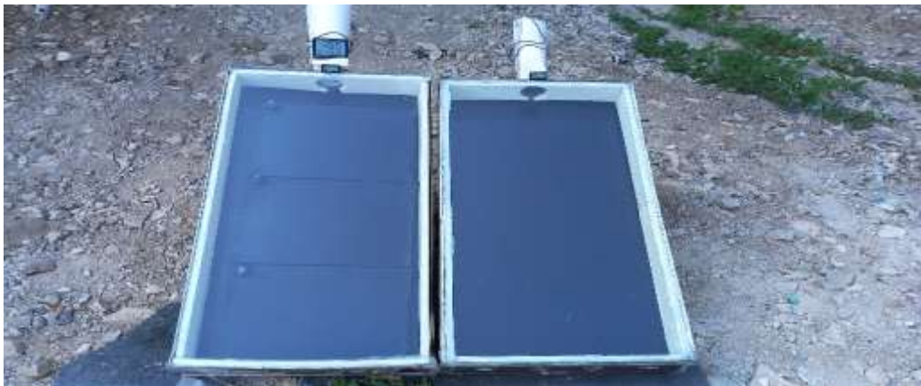
الشكل (1) اللاقطين الهوائيين المصنوعين أحدهما مع مادة متغيرة الطور والأخر بدونها
