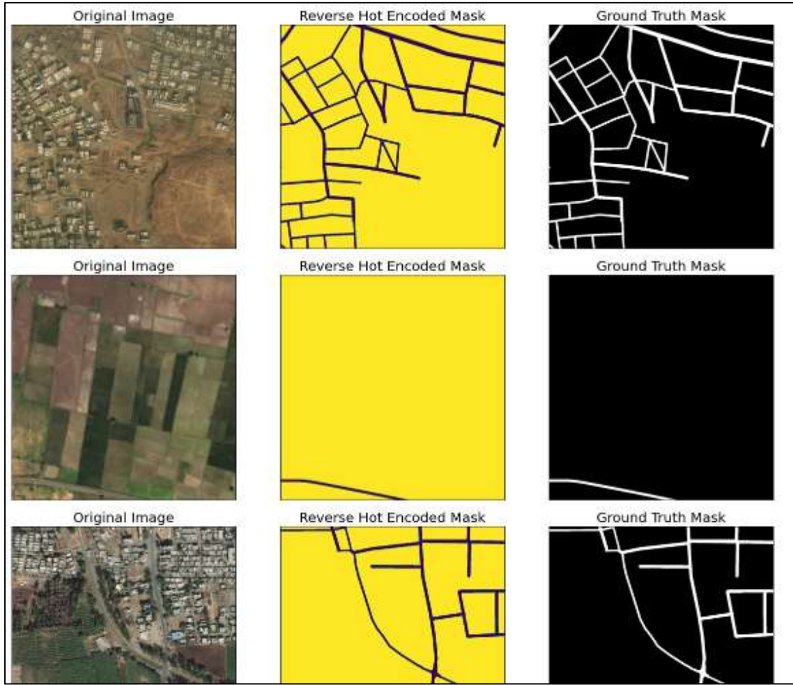
الشكل (6). إجراء المعالجة المسبقة لمجموعة البيانات واستخلاص صور الحقيقة الأرضية (Ground Truth Mask)
