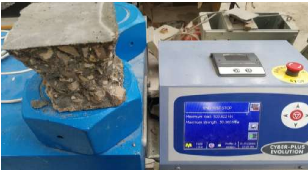
شكل (6): نتيجة اختبار عينة على الضغط البسيط
