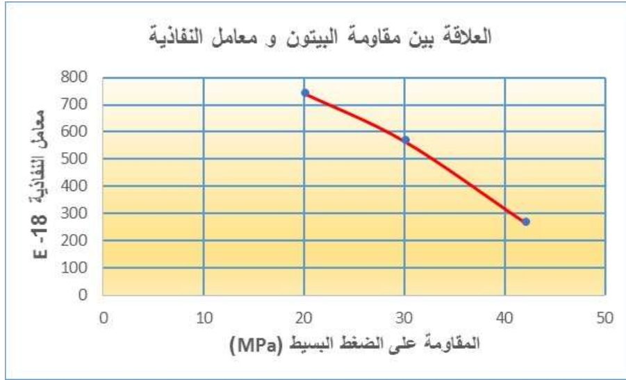
الشكل (8): العلاقة بين نفاذية البيتون للهواء ومقاومته على الضغط البسيط.
