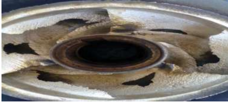
الشكل (7-2-1) يبين شفرة مضخة متآكلة
