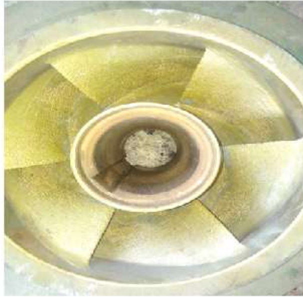
الشكل (9) شفرة برونزية للمضخة.
