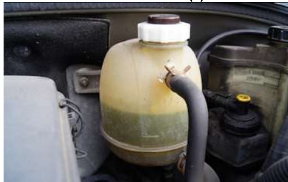
الشكل (4): خزان المياه الاحتياطي لدارة التبريد.
