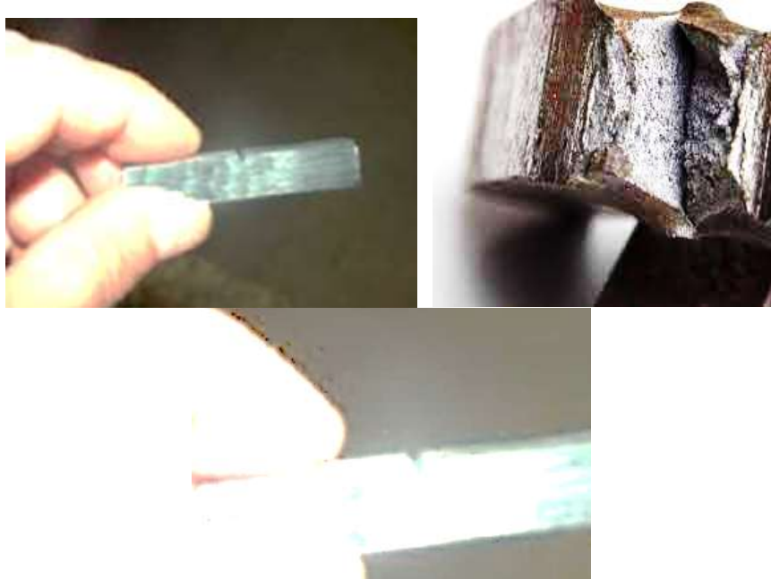
الشكل (6) إحدى عينات الصدم ومقطع الكسر في فولاذ هادفيلد D مع Cr, Mo
