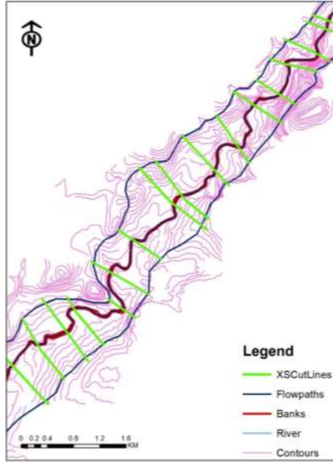
الشكل (4) مرحلة رسم طبقة النهر والضفاف والضفاف الفيضانية وتحديد مسار الجريان ورسم المقاطع العرضية.
