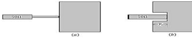
الشكل (4) (a) تغذية من الجانب Edge Feed (b) تغذية جانبية داخلية Insert Feed
