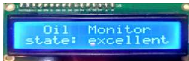
الشكل (3) شاشة LCD1602 المستخدمة.
