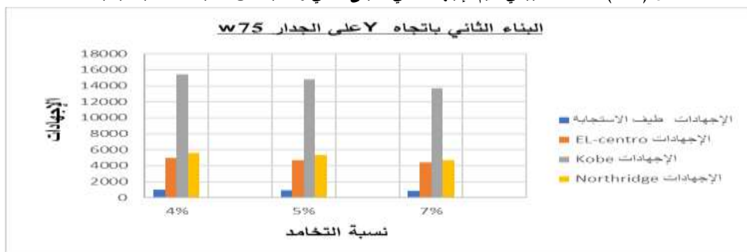
الشكل (4-7): المخطط البياني لقيم الإجهادات في المبنى الثاني والناتجة عن السجلات المطبقة باتجاه Y
