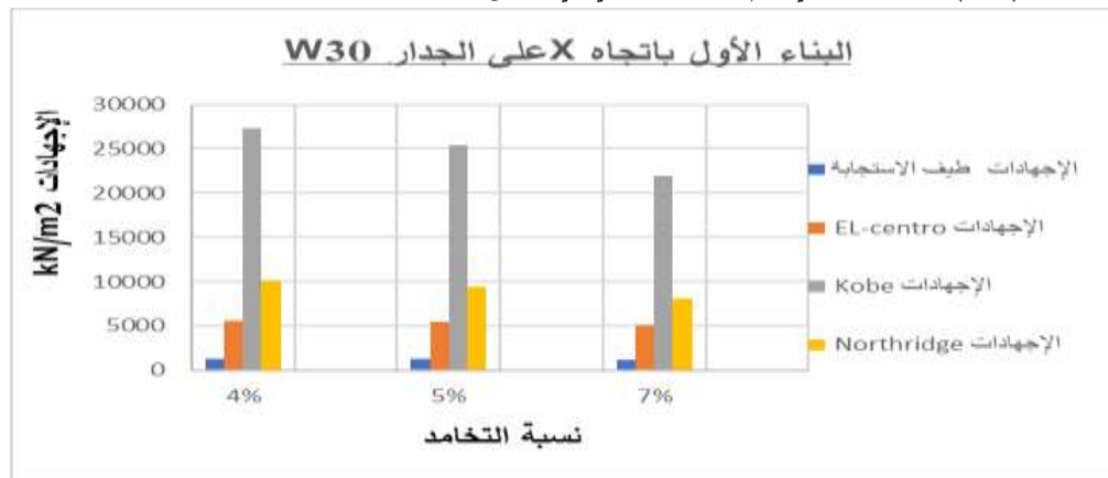
الشكل (3-6): المخطط البياني لقيم الإجهادات في المبنى الأول والنتيجة عن السجلات المطبقة باتجاه X
