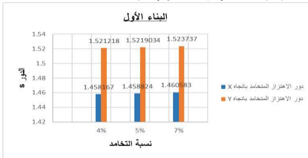
الشكل (3-3): المخطط البياني لقيم دور الاهتزاز المتخامد في المبنى الأول بالاتجاهين X,Y
