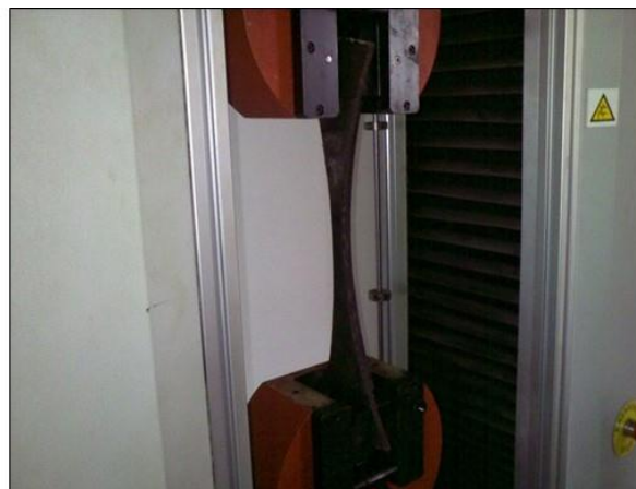
الشكل (5-a): تثبيت عينة الاختبار بين المقابض
