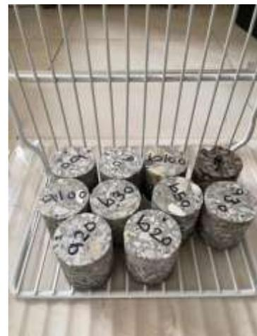
الشكل (3) اختبار الامتصاص الشعري بالماء للعينات الاسطوانية
