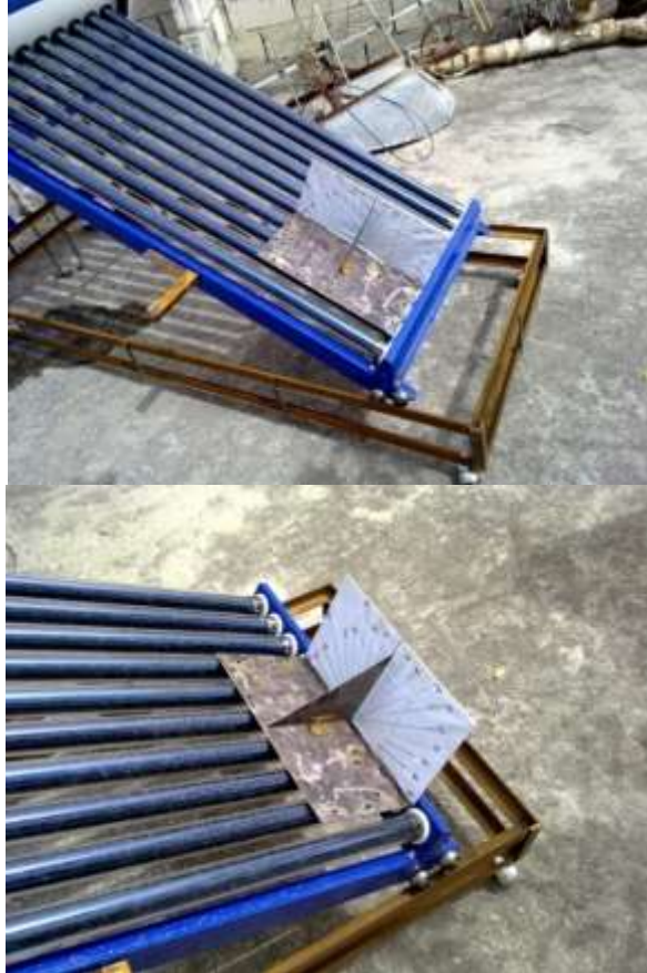
الشكل (2) يبين طريقة حساب زاويتي الميلان الطولية والعرضية
