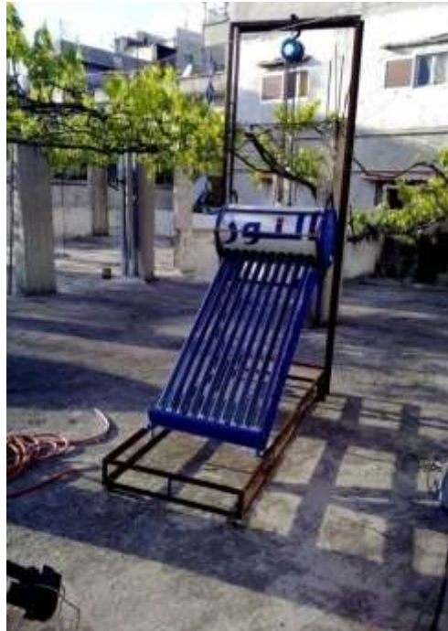
الشكل (1) يبين القاعدة التي نتحكم بواسطتها باتجاه اللاقط وزاويته
