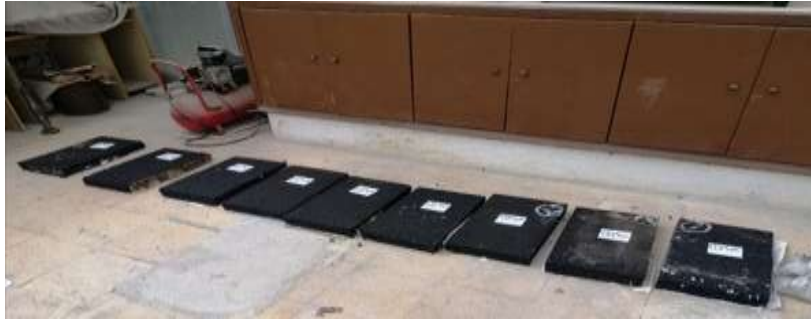
الشكل(6):تسلسل العينات من رقم (1) إلى (9) (توضح القوالب مع وبدون تسليح).
