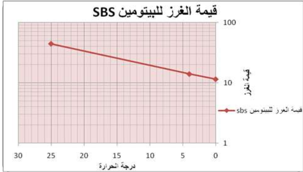
يوضح هذا المنحني (3) تغيرات قيم الغرز للبيتومين A.SBS بتغير درجات الحرارة
