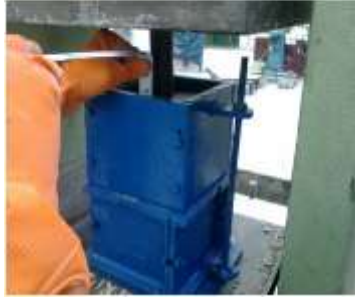
الشكل (8) وضع القالب مع امتداده على المكبس الهيدروليكي وتطبيق الضغط اللازم للإملاء
