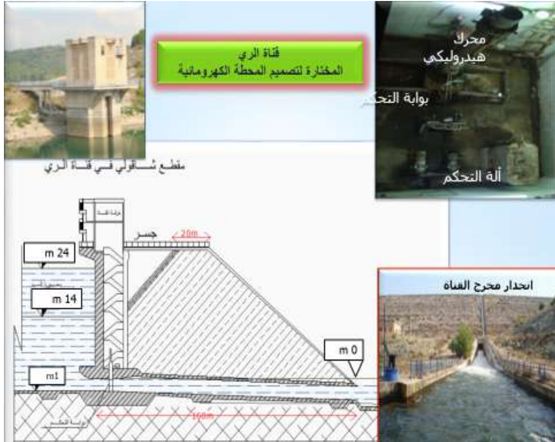
شكل (4) يبين صور ومخطط لتصميم قناة الري.
