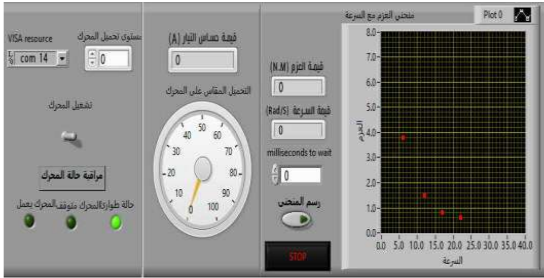
الشكل (23): تشغيل الإيقاف الآلي عند الوصول إلى حالة الطوارئ من الواجهة التفاعلية
