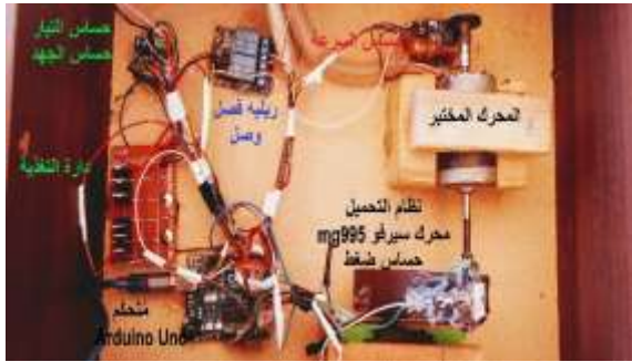
الشكل (18): اختبار النظام المُصمّم على محرك تيار مستمر DC ذو استطاعة 24 واط
