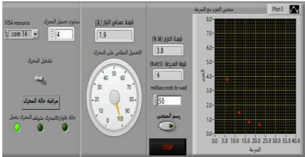
الشكل (22): عرض قيم البارامترات ومنحنى سرعة - عزم لمحرك الـ DC عند مستوى التحميل الرابع
