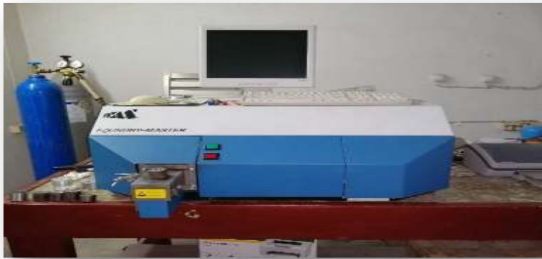
الشكل (1) جهاز التحليل الكيميائي Foundry-Master
