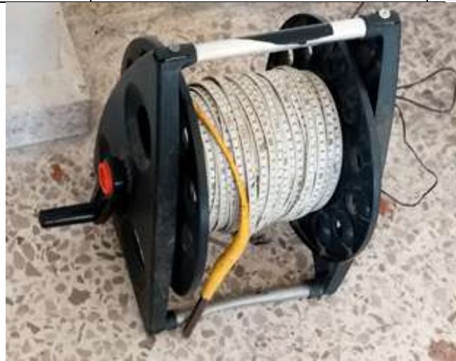
الشكل (1) جهاز قياس مناسيب الماء في الآبار البيزومترية الموجودة في السد.
