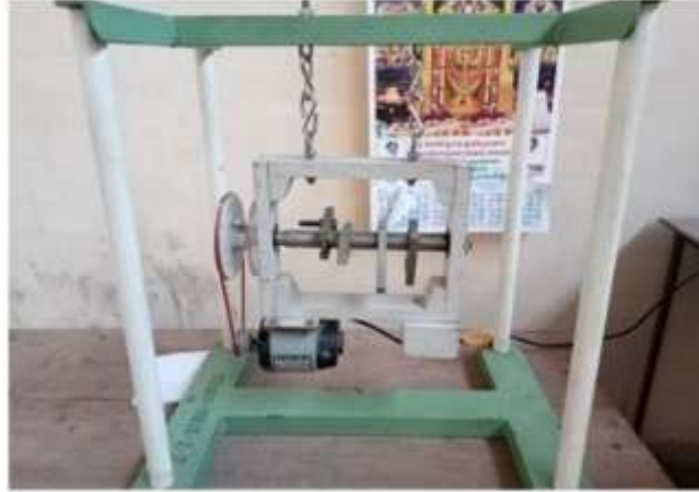
الشكل (3) نظام الدوار المرن [2]
