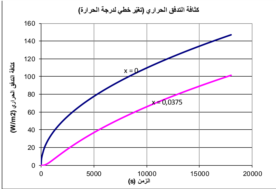
الشكل 2: تغيّر كثافة التدفق الحراري تبعاً للزمن من أجل تغيّر خطي لدرجة حرارة السطح.
