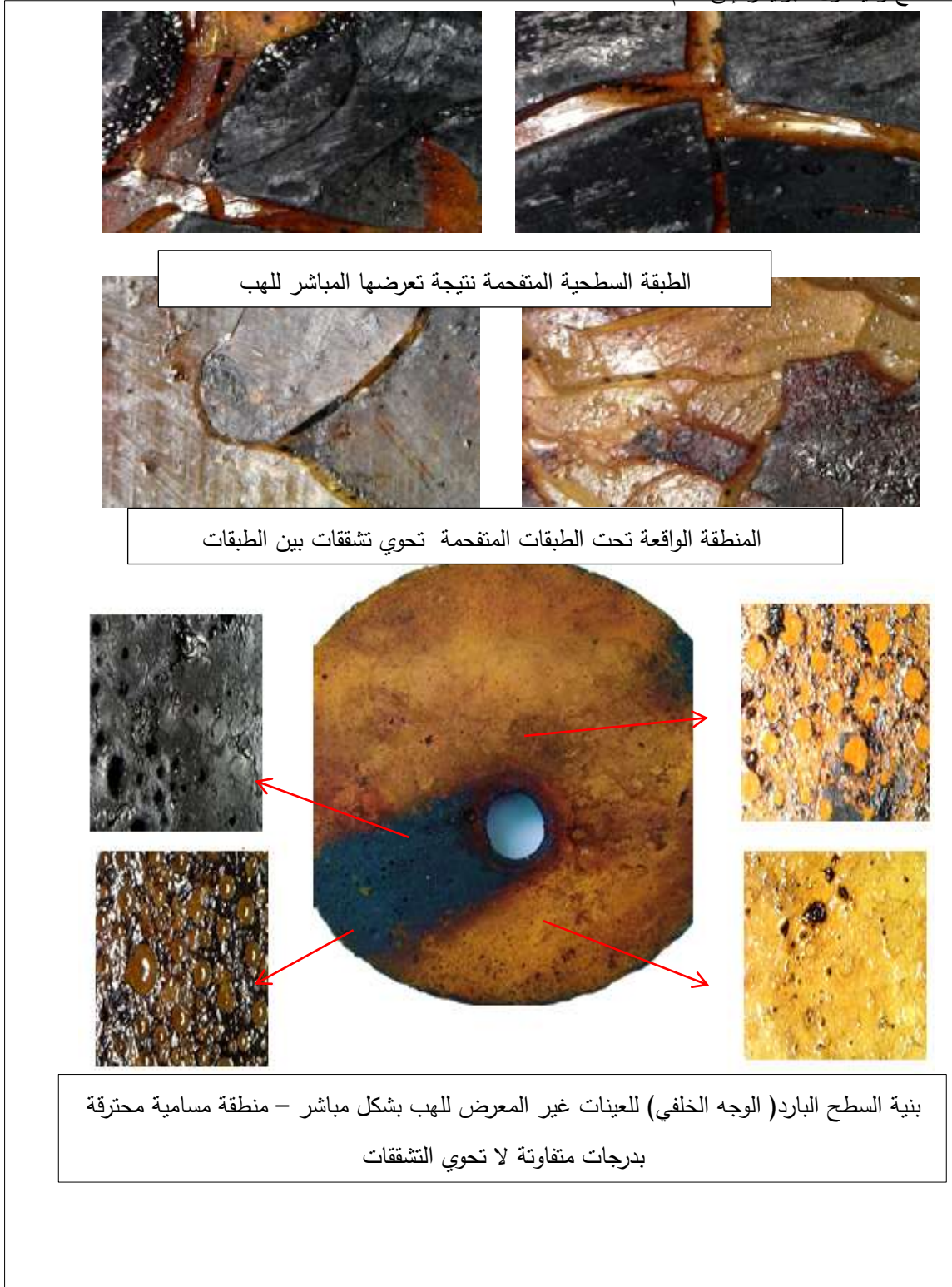
الشكل (7) - صور ميكروسكوبية بتكبير (500X) تظهر التشققات الحاصلة على سطح عينات UPR المختبرة نتيجة تعرضها للهب
