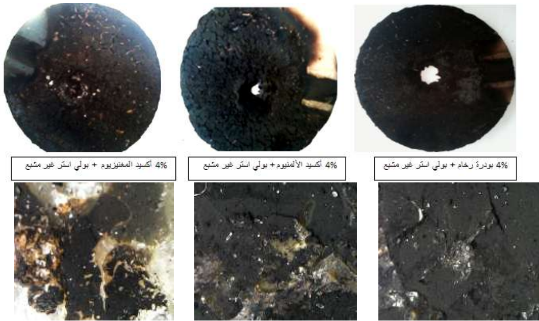
الشكل (6) - صور فوتوغرافية وميكروسكوبية بتكبير (500X) لسطح عينات UPR مضاف إليها 4% لكل من بودرة الرخام، أكسيد الألمنيوم، وأكسيد المغنيزيوم بعد تعريضها للهب لمدة دقيقة.
