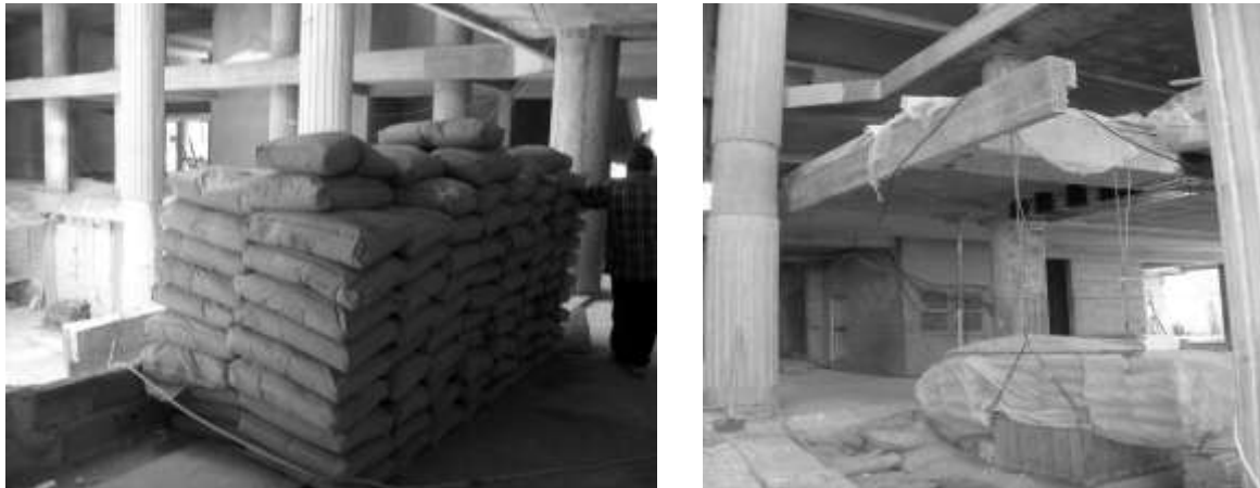
الشكل (8) صور تحميل العناصر الإنشائية بالحمولة الحية والميتة
