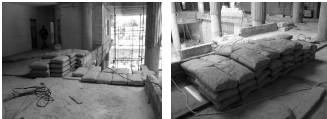
الشكل (7) صور طريقة تحميل العناصر الإنشائية بالحمولة الميتة
