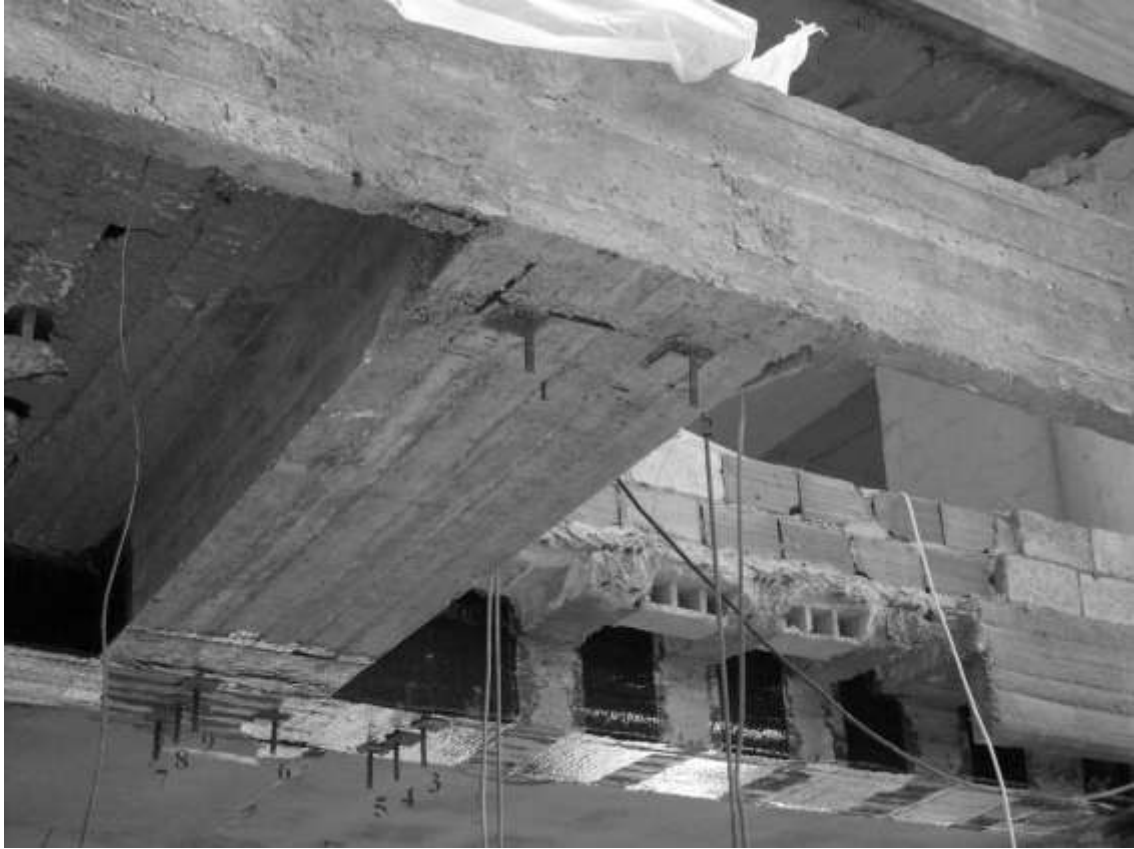
الشكل (5) توضع نقاط المراقبة الارتفاعية وأرقامها أسفل سطح العنصر الإنشائي المختبر
