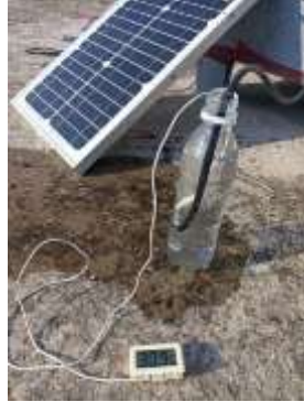
الشكل (10) مقياس درجة حرارة الماء عند مخرج اللوح (PV/T) (مدخل السخان الشمسي)
