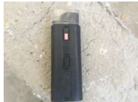
الشكل (3) مسطرة التشققات ومكبر لقياس عرض الشقوق
