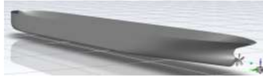
الشكل 1: نموذج سفينة الصب المستخدمة مع الرفاص MOERI MP687 الخاص بها [23], [3].
