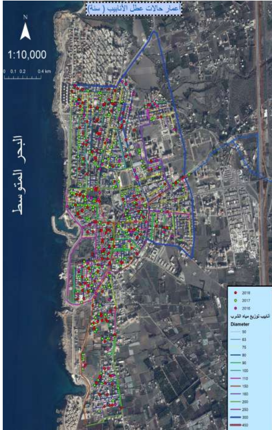
الشكل (5) أعمار حالات عطل أنابيب المياه بمدينة جبلة (سنة)
