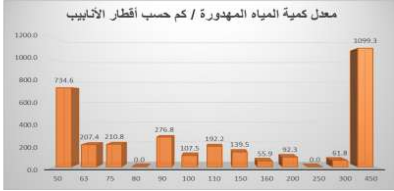
الشكل (8) معدل كمية المياه المهدورة / كم حسب أقطار الأنابيب
