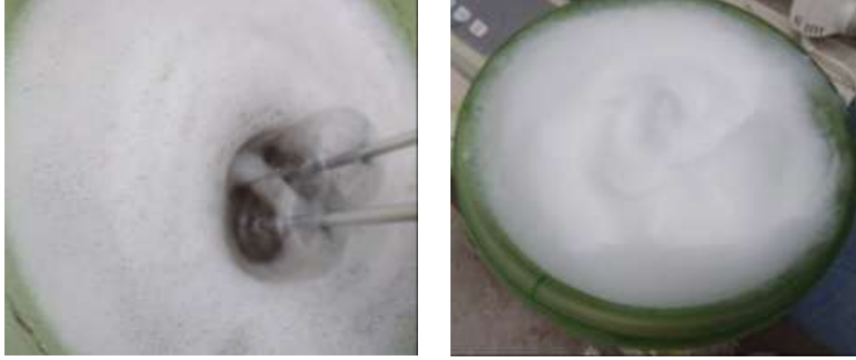
الشكل (2) تشكيل الرغوة اللازمة بطريقة الرغوة مسبقة التشكيل
