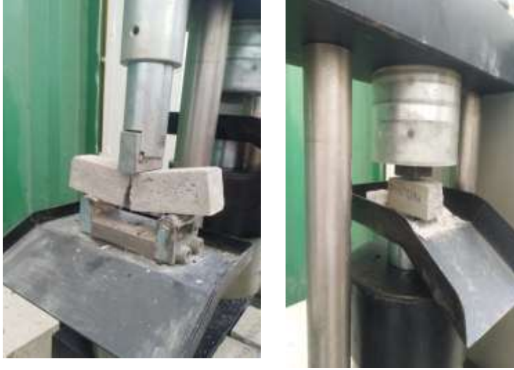
الشكل (6) يوضح اختبار الشد بالانعطاف واختبار الضغط البسيط لإحدى عينات البيتون الرغوي
