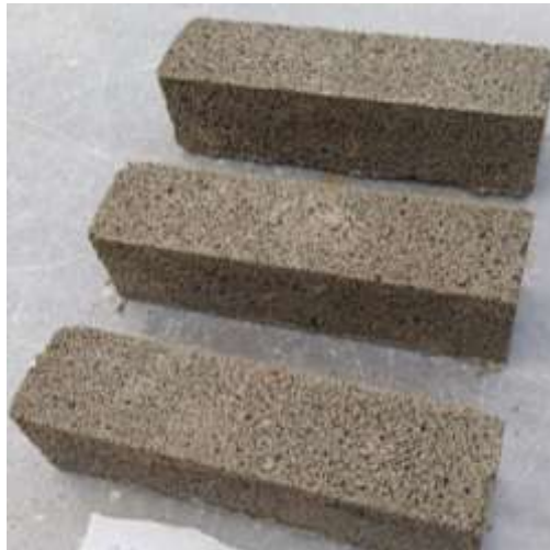
الشكل (5) يوضح شكل عينات الببتون الرغوي المتصلب بعد الفك
