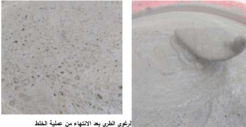
الشكل (3) يوضح قوام البيتون الرغوي الطري بعد الانتهاء من عملية الخلط
