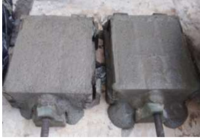
الشكل (4) يوضح شكل عينات الببتون الرغوي الطري بعد صبها لإحدى الخلطات
